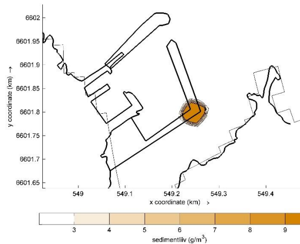
Joonis 2.10. Heljumi levik lõunamuuli täitmise ajal 2 tundi pärast tööde algust. Tuule suund on 45°.
