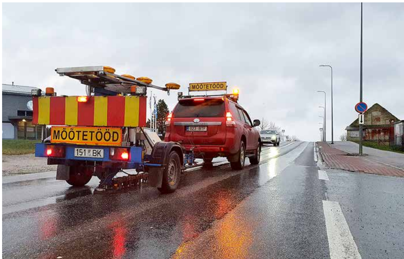
FWD-seadmega mõõdeti tee aluskonstruktsiooni kandevõimet. Foto: Kalev Ensaar
