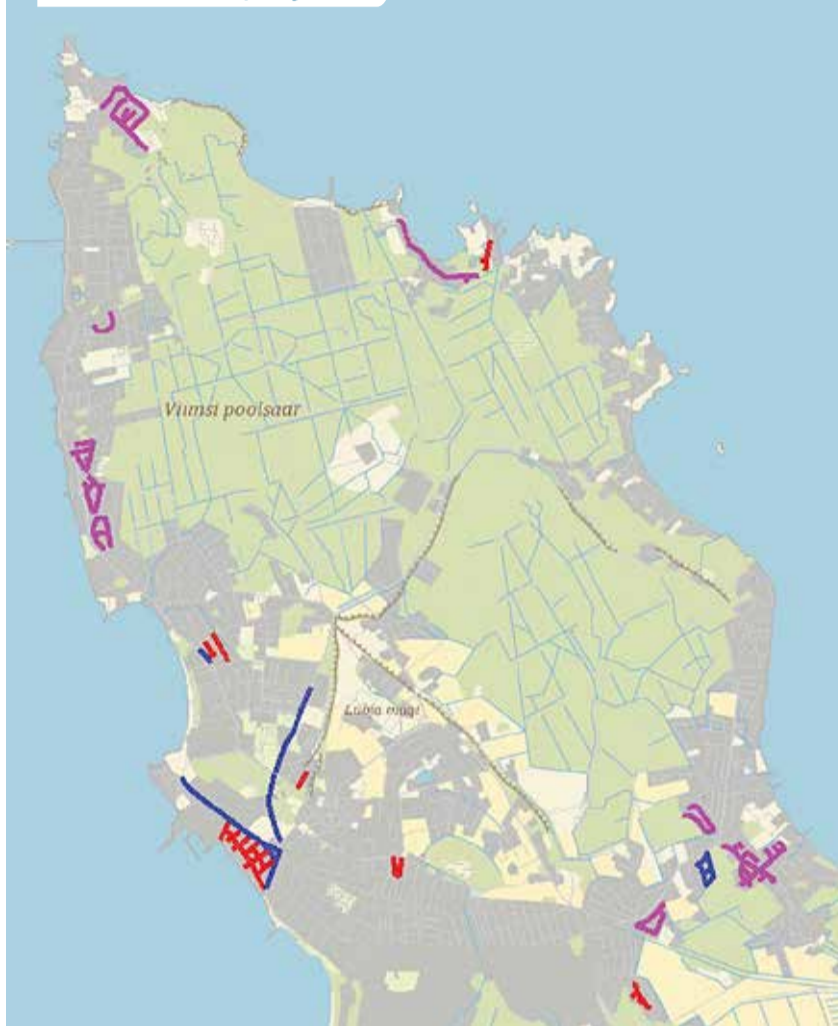
Punane – täielik renoveerimine maakaabli ja metallmastidega; sinine – valgustite vahetus; lilla – renoveerimine õhukaabliga. Skeem: AS KH Energia-Konsult, kasutatud Maa-ameti aluskaarti.
