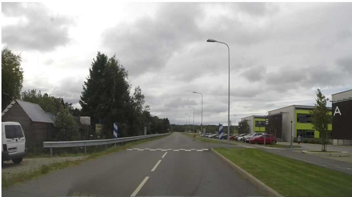
Foto 25. Liikluse rahustamiseks tõstetud teekate G.H.Schüdlöffeli teel
