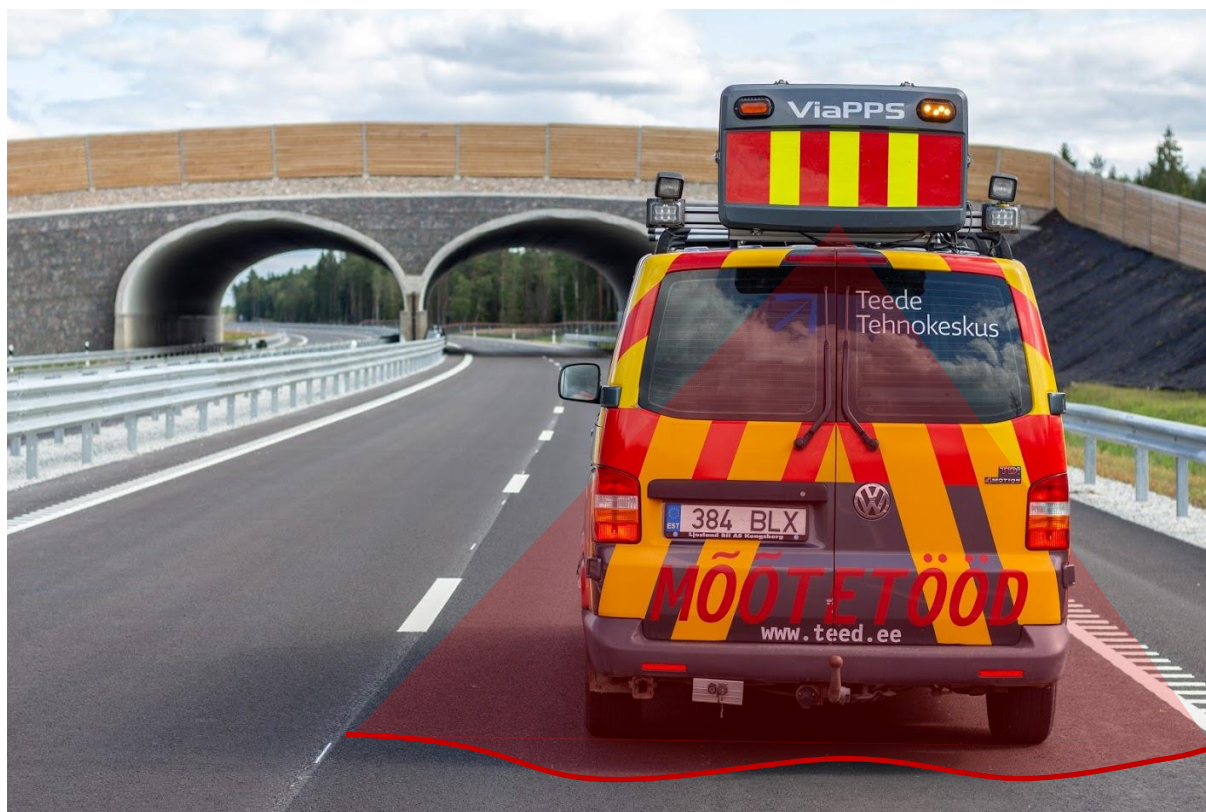
Foto 10. Roopa sügavuse mõõtmisel kasutatav laserskanner ViaPPS
