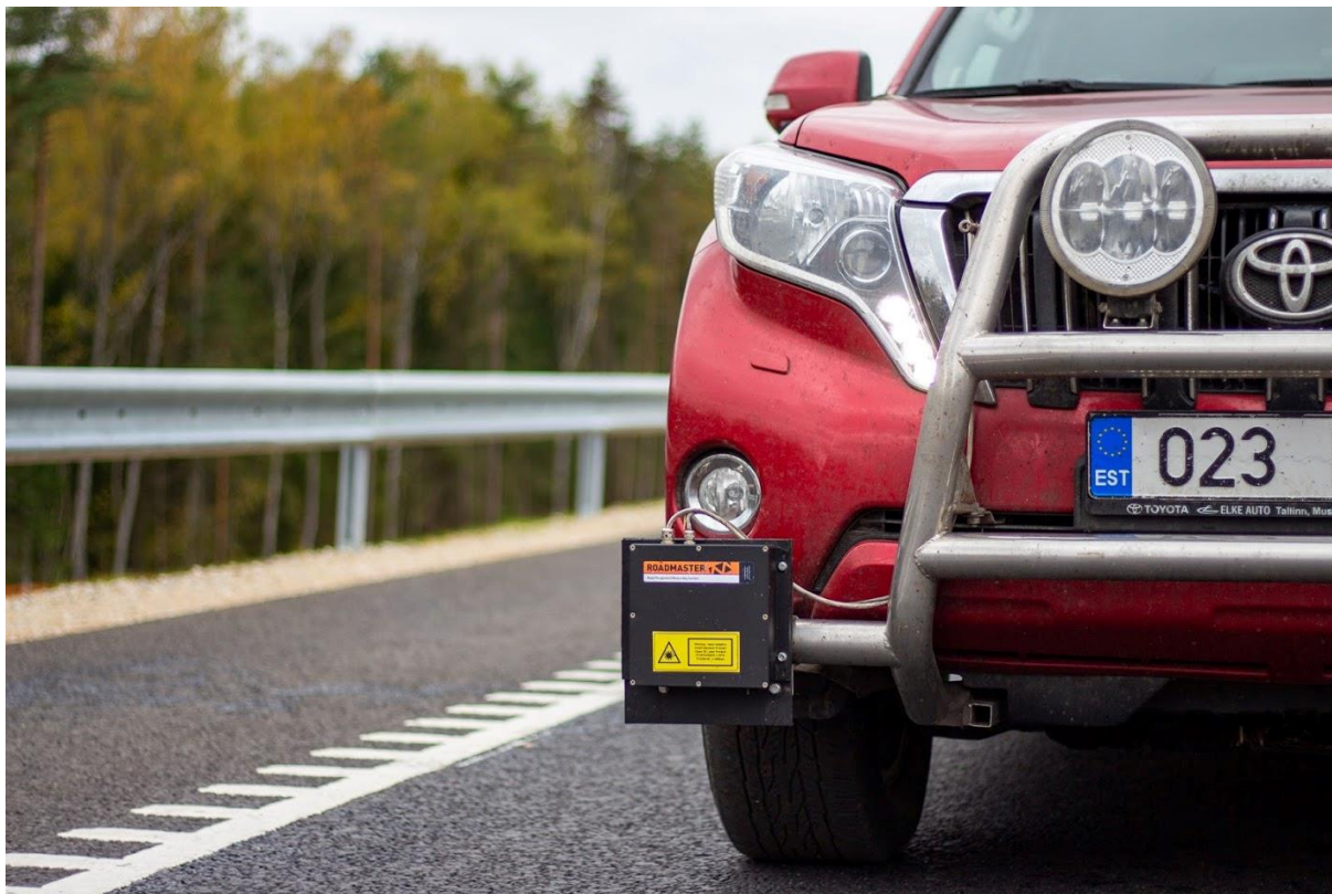
Foto 9. Tasasuse mõõtesead RoadMaster LaserTextureMeter asetatuna mõõteauto külge
