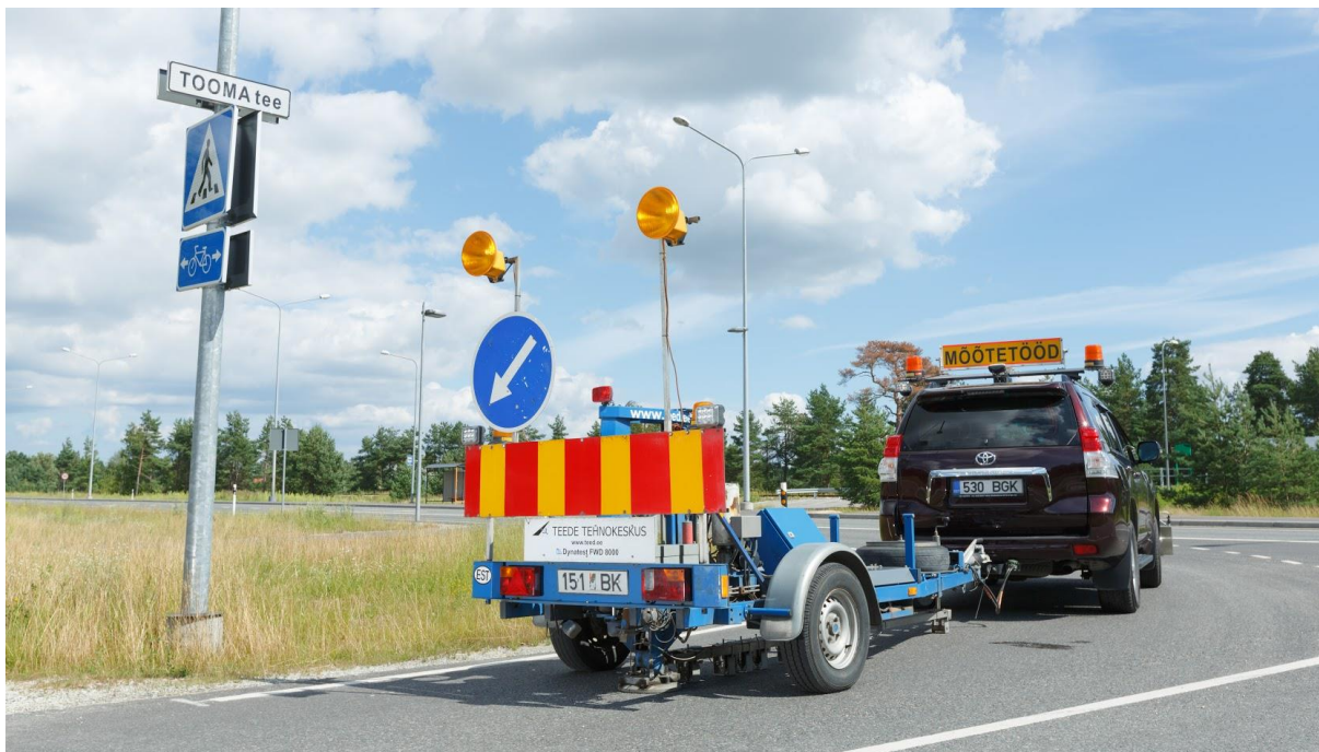
Foto 11. Teekonstruktsiooni kandevõime mõõtesead Dynatest FWD-8002
