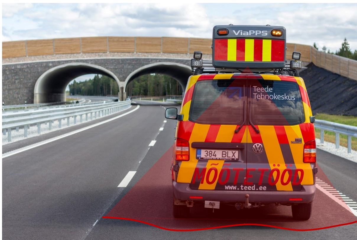
Foto 10. Roopa sügavuse mõõtmisel kasutatav laserskanner ViaPPS
