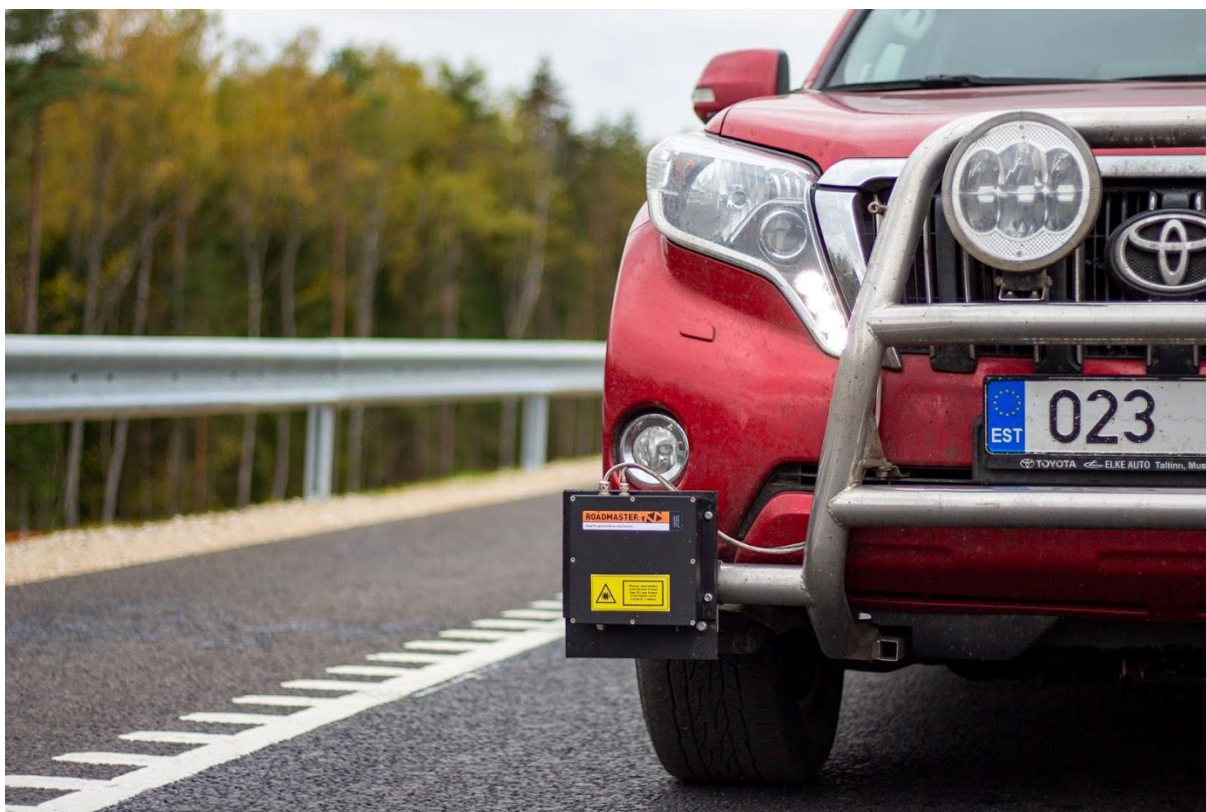
Foto 9. Tasasuse mõõtesead RoadMaster LaserTextureMeter asetatuna mõõteauto külge
