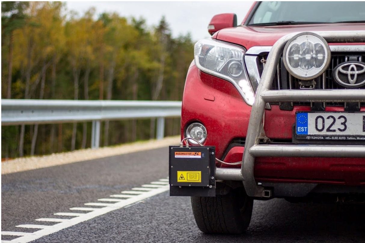
Foto 9. Tasasuse mõõtesead RoadMaster LaserTextureMeter asetatuna mõõteauto külge
