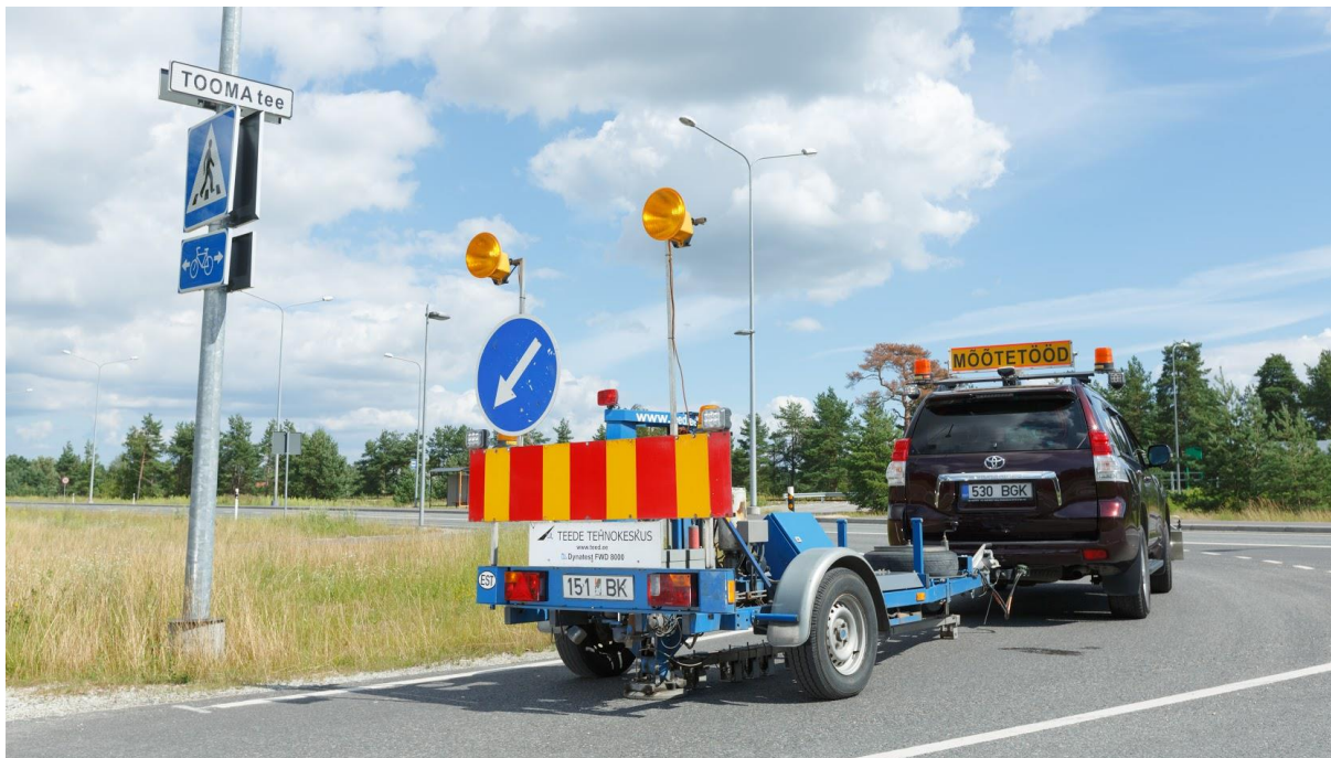
Foto 11. Teekonstruktsiooni kandevõime mõõtesead Dynatest FWD-8002
