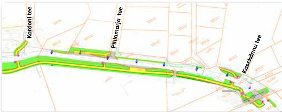
Muuga kergliiklustee lõpuosa joonis. Antud lõigule rajatakse kaks uut bussipeatust koos kergliikurite aladega, lisaks neli ülekäigurada, et tagada ühendus erinevate piirkondade vahel, ning samuti saab Muuga sõidutee lõik valgustuse. Joonis: OÜ InfraProjekt
