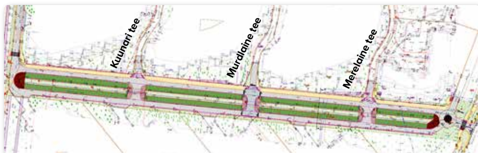
Mereranna tee taristu ja tee rekonstrueerimise järgne lahendus. Parkimiskohad ehitatakse pärast taristu rekonstrueerimist muruparklaks, liiklus saab kummalgi sõidupoolel olla ühesuunaline. Joonis: OÜ Esprii
