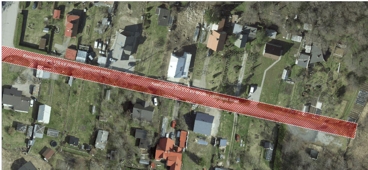
Joonis 43. Teelõigu Kallavere-Viimsi 110kV liini kaitsevöönd
