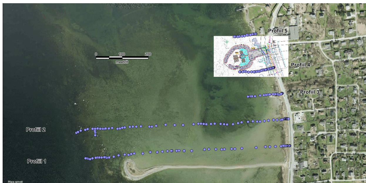
Joonis 2.1. Ristprofiilide asukohad Altsauna lautri piirkonnas. Iga kolmnurk tähistab ühte mõõtepunkti (alusena on kasutatud Maaameti uusimat ortofotot).
