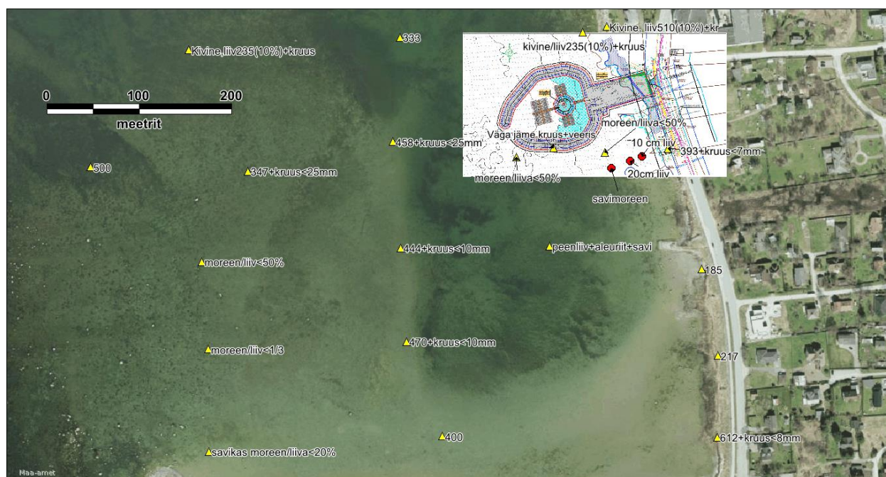
Joonis 3.4. Kollased kolmnurgad tähistavad settekopaga võetud merepõhja- või rannasetete proovide asukohti. Kolmekohaline number tähistab selles piirkonnas levivate liivaterade mediaanväärtust. Lisaks sellel on esitatud samas proovis olnud muu materjal ja selle osakaal. Planeeritavats sadamast lõunas tehti kolm kontrollpuurimist liiva tuseduse määramiseks. Kaardile on kantud ka puurimisel saadud andmed.
